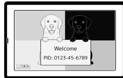
「はい」を選択した場合は、SWキーを5秒間押し続けてください。LEDが白く点滅し始めたら、キーを放してください。その後、画面が次のように更新されてアートはMatterコミッショニングモードに入ります。
